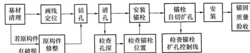
图4 自扩底锚栓施工工序示意
