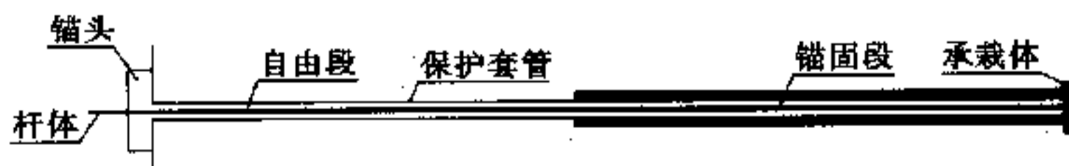
图 4.2.2 压力型预应力锚杆结构原理
